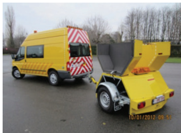
Obr. 4: Přívěs pro měření metodou CPX (Úřad pro pozemní komunikace a dopravu – Vlámská vláda - Belgie)
