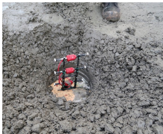
Obr. 12: Situace umístění tenzometrů a teplotních čidel v CBK, pohled na 1 měřicí místo.
