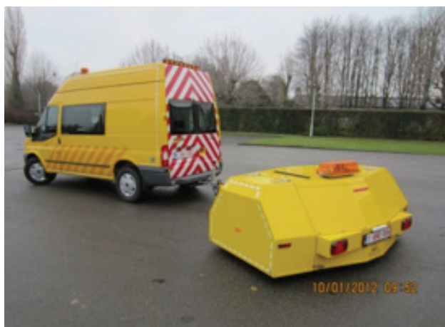
Obr. 4: Přívěs pro měření metodou CPX (Úřad pro pozemní komunikace a dopravu – Vlámská vláda - Belgie)
