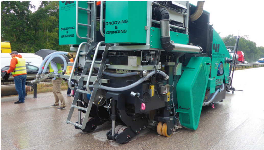
Bild 3: Fräse mit Diamant-Trennscheiben zur Wiederherstellung von Ebenheit, Griffigkeit und lärmindernder Eigenschaften
