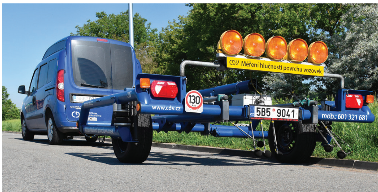
Obr. 1: Ukázka měření v terénu metodou CPX v souladu s ISO 11819-2 pomocí měřicího přívěsu.
