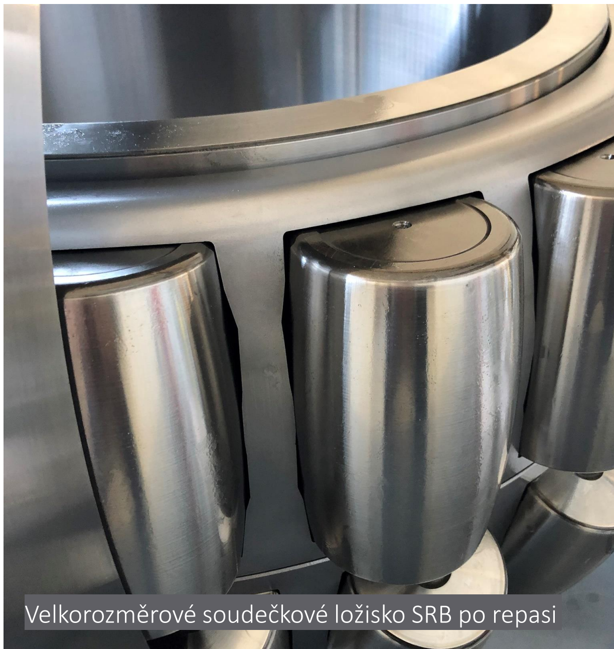
Velkorozměrové soudečkové ložisko SRB – po repasi & BO povlaku
