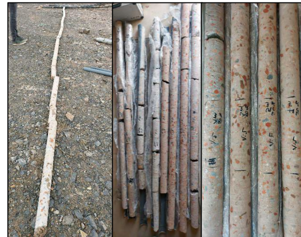
Piloty bez známky segregace či výchylek pevnosti v délce piloty.
