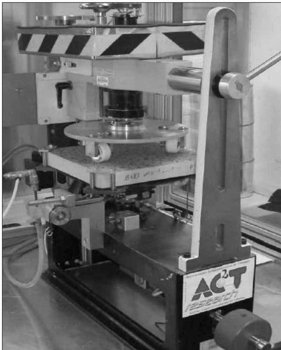
Obrázek 4: Tribometer pro vymývaný beton
