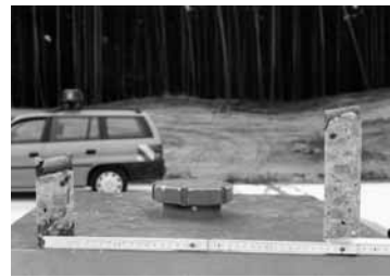
Dübelschräglage anhand von 2 Bohrkernen
