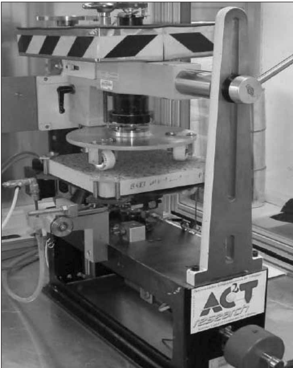
Abbildung 4: Tribometer für Waschbeton
