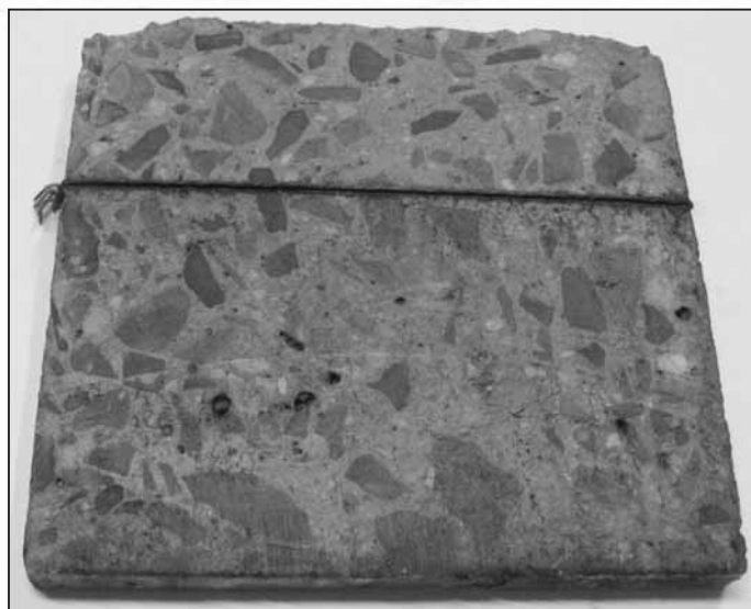
Obr. 4 - Ukázka stavu experimentálního vzorku po 2 letech uložení vedle vozovky - Emcoril AC.
