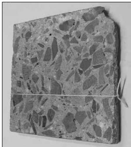
Obr. 2 – Ukázka stavu experimentálního vzorku po 2 letech uložení ve sklepě - Emcoril AC.
