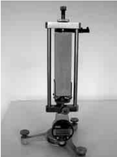
Obrázek 1: Měření prodloužení trámečku
