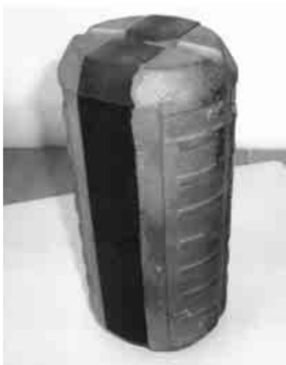
Obr. 15 Konektor LCPC Freyssinet vyžaduje otvor o průměru 80 mm
