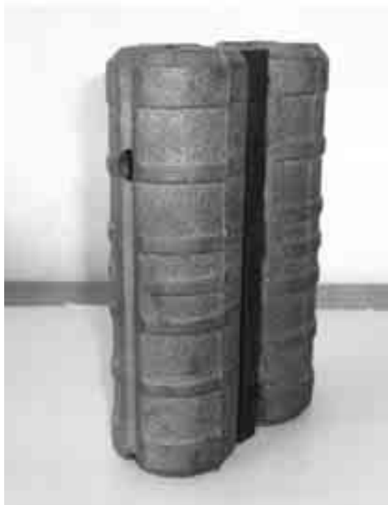
Obr. 17 Konektory DSH byly aplikovány na zkušebních úsecích dálnice D2 a D1
