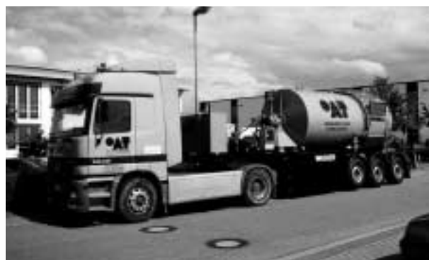
16 m 3 -Fahrmischer für Schnellbeton.
