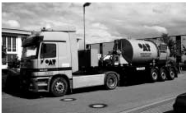
Pojízdňá míchačka 16 m 3 pro rychletuhnoucí beton.
