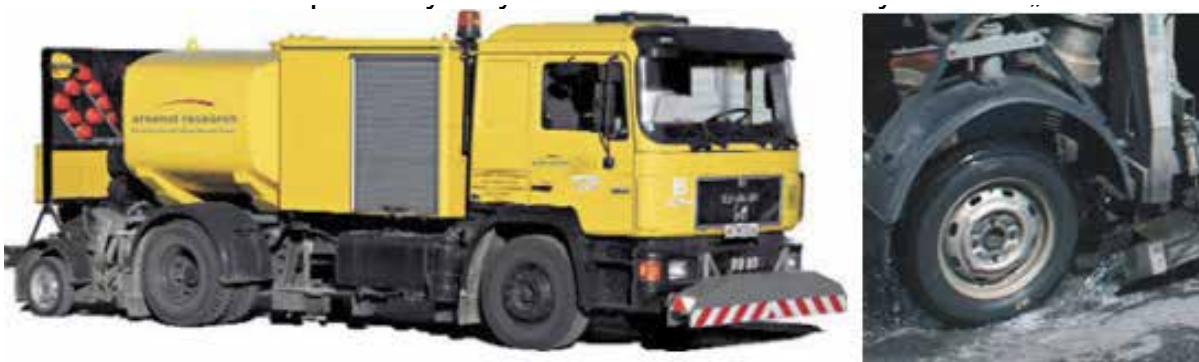
Bild 8: Messung der Griffigkeit der Fahrbahnoberfläche mit dem System „RoadStar“
