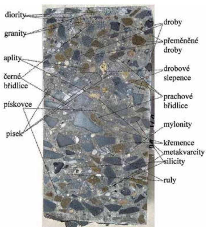
Obrázek 3: Příklad makroskopické kvalitativní identifikace hrubého kameniva na řezu vývrtem.
