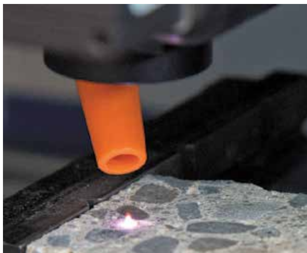
Obrázek 7) Schématické znázornění LIBS – ozařovaný povrch a excitace povrchu betonu laserovým paprskem
