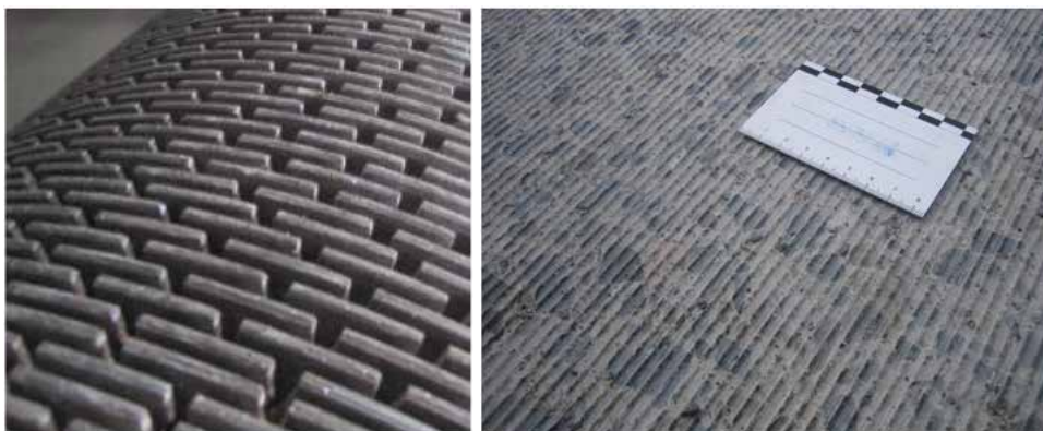
Obrázek 2) vlevo (a) brousící hlava, vpravo (b) typická textura diamantového brusu
