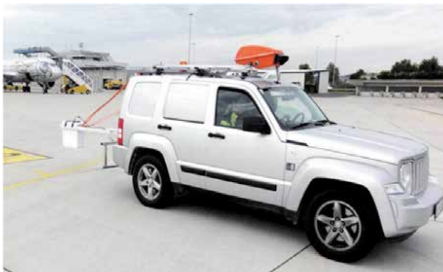
Bild 6: Messung mit dem Georadar
