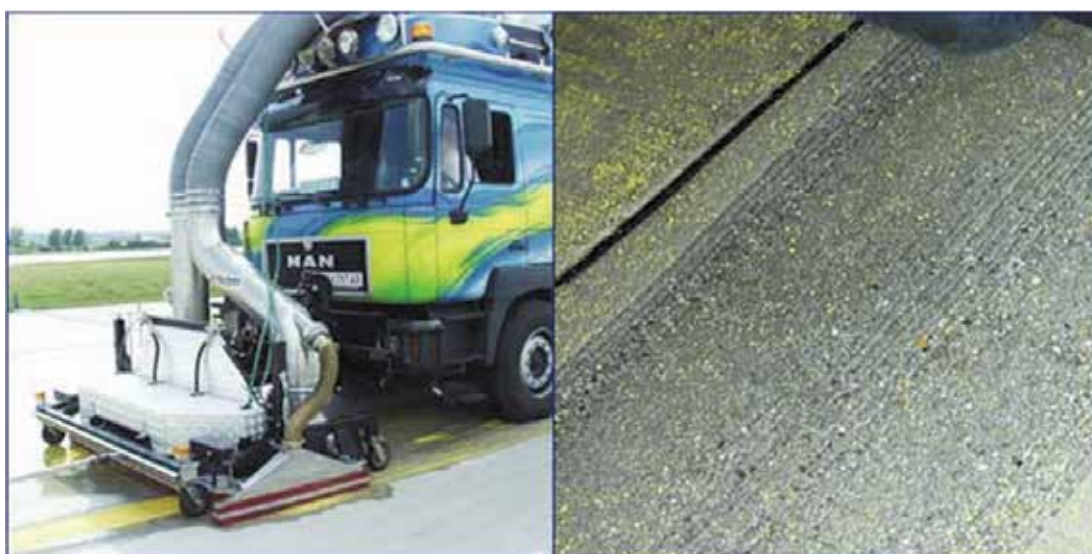
Obrázek 1: Tryskání povrchu cementobetonového krytu vysokotlakým vodním paprskem
