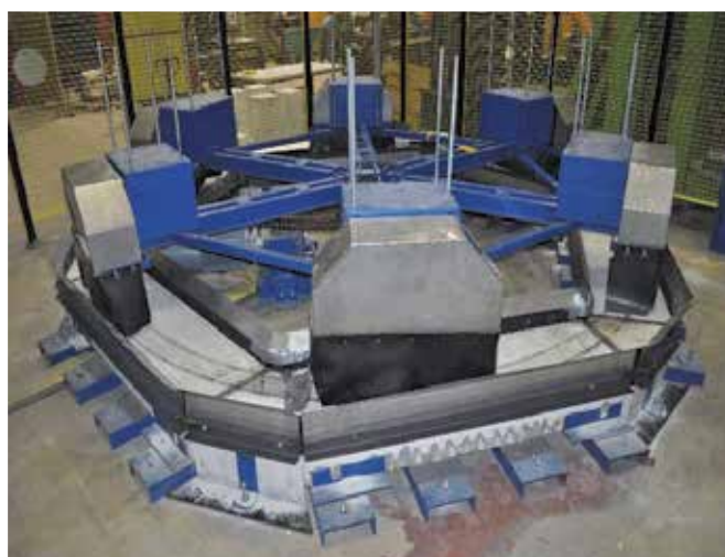
Obrázek 9) Zařízení pro simultánní zkoušky šesti velkých betonových nosníků s roztokem chloridu sodného, aplikovaným na horní stranu
