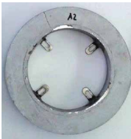
Obr. 3 Prstence pro měření vzniku první makrotrhliny. Vpravo obrázek lokalizované makrotrhliny na vzorku malty.
