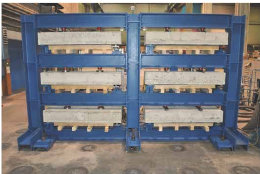
Obrázek 4) Testovací zařízení pro současně testování šesti velkých betonových nosníků
